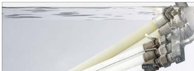
3-4. ábra Csövek hosszú távú vizsgálatban (nyomás alatt vízmedencében)
