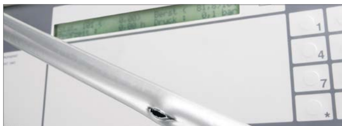
3-1. ábra Repezstőnyomás vizsgálat eredménye az univerzális RAUTITAN flex csőnél
