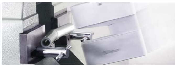
3-2. ábra Univerzális RAUTITAN flex cső ütővizsgálata készülékben
